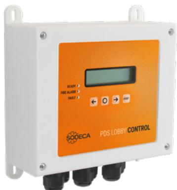
Cuadro de control y regulación automática independiente para sistemas de presurización de vestíbulos según norma EN 12101-6, compatible con los sistemas KIT BOXPDS y KIT BOXPDS SMART actuando como sensor de presión remoto, y con control automático de compuertas para mantener la sobrepresión en los vestíbulos en caso de incendio.
