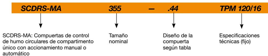
**Diseño de la compuerta**
