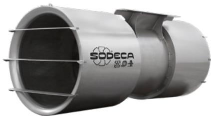
Jet fan unidireccional, de gran robustez y hélice en fundición de aluminio para empujes medios. Diseñados especialmente para la ventilación de túneles y para la evacuación de humo en caso de incendios certificados 400 °C/2h y 300 °C/2h según modelo.
