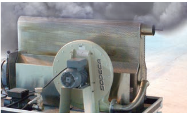
Máquina de humos, para realizar las pruebas reales de humos
