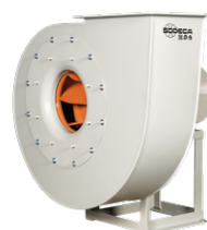
CAMA Ventiladores centrífugos de media presión y simple aspiración de gran robustez con envolvente y turbina en chapa de acero Diseñados para aire con polvo
