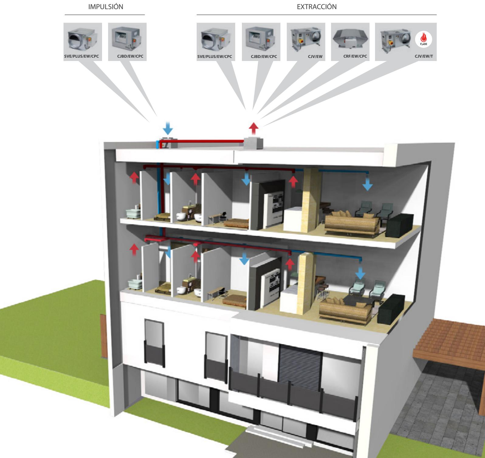
De esta forma se puede garantizar una presión constante en el sistema de conductos, sea cual sea el número de viviendas y la cantidad de bocas de extracción o impulsión, adaptando el caudal de aire a las necesidades de cada vivienda.
