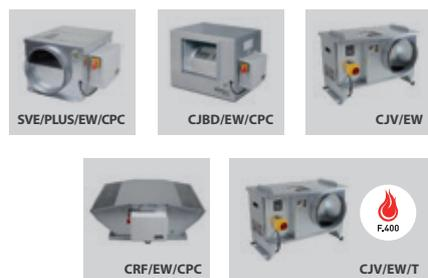
Para la **extracción** se puede utilizar, los modelos siguientes, teniendo en cuenta que el modelo CJV/EW/T, además tiene certificación F-400 para trabajo a 400°C/2h siendo apto para la evacuación de humo en caso de incendio de la vivienda.
